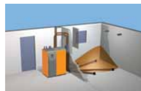
Silo de stockage des pellets avec sondes d'aspiration
