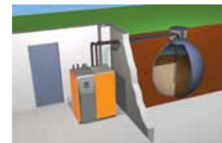
Silo enterré à l'extérieur
