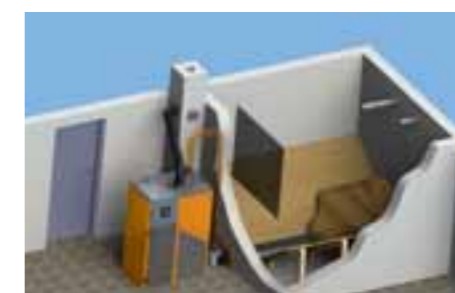
Silo avec vis collectrice centrale
