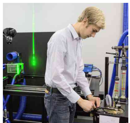
Forscher der Hochschule Luzern mit dem Versuchsaufbau für Strömungsmessungen an einem Modell (mit Laser und «Particle Image Velocimetry»).
